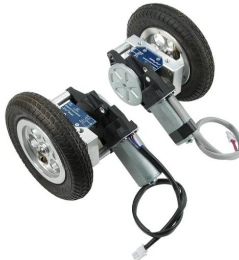
Anlage 6 - Optischer Encoder und dessen Installationsposition[5]
