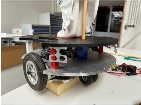
Verbindung und Installation der Säule mit dem Holzstab
