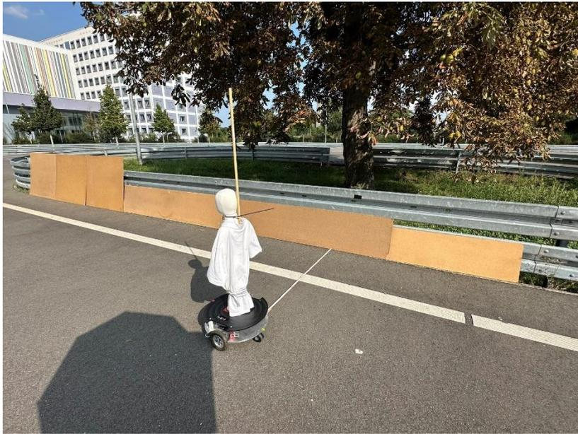
Anlage 36 - Bestimmung der Anfangsrichtung und -position des Roboters
