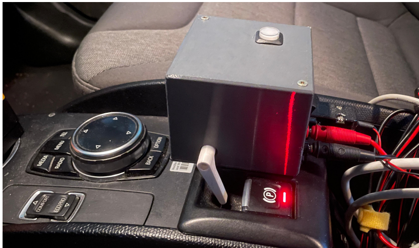
Abbildung 4.16.: Realisierung der Verzögerung über einen CAN-gesteuerten Feststellbrems-Aktuator
