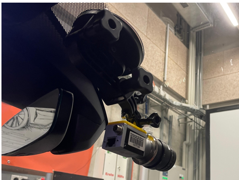
Abbildung 4.14.: Kamerabefestigung an der Windschutzscheibe mithilfe einer Saugnapfhalterung
