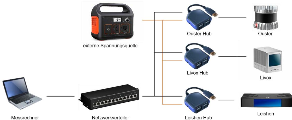
Abbildung 3.4 Strukturdiagramm von Geräteverbindung
