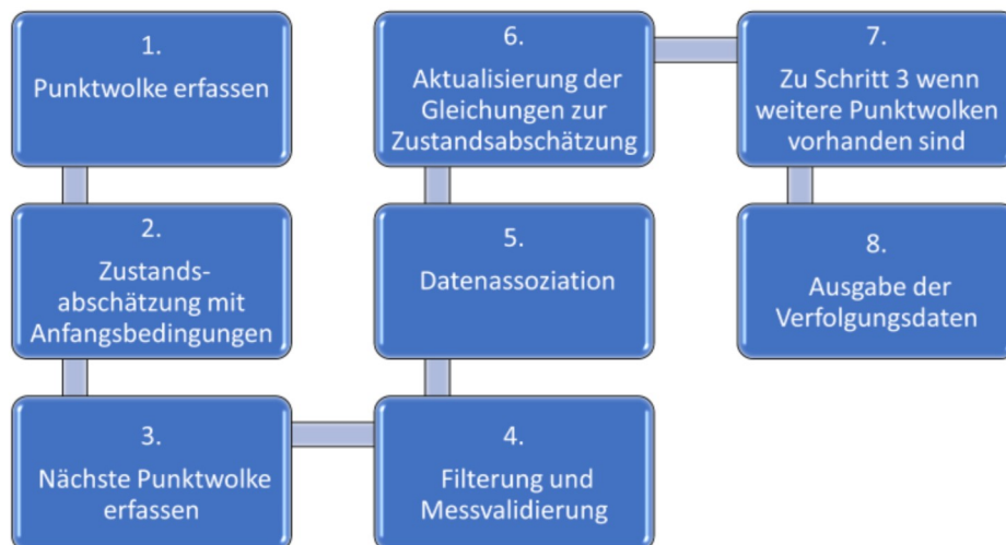
Abbildung 3.2. Flussdiagramm eines JPDA Trackers [17]
