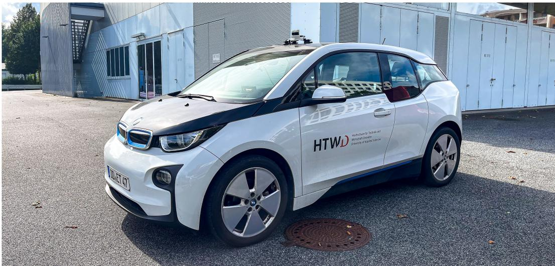
Abbildung 4.3.: BMW i3 mit montiertem LiDAR-Sensor
