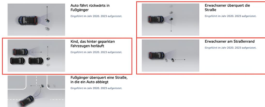
Abbildung 5.10.: Mögliche und davon ausgewählte EURO-NCAP Notbrems-Testszenarien [69]
