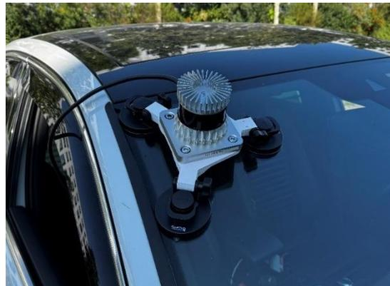
Abbildung 3.5 Platzierung des LiDAR-Sensors am realen VUT
